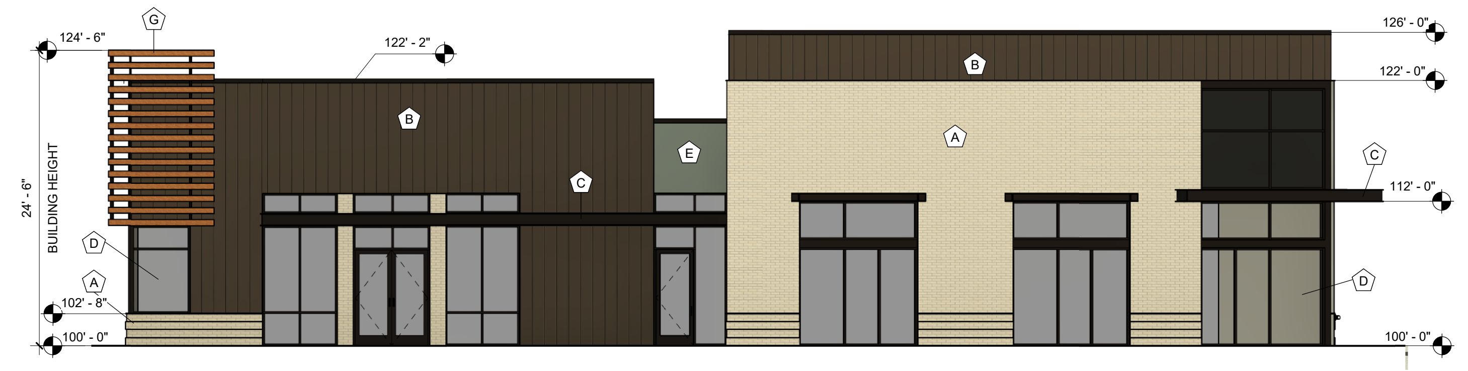
3 WEST ELEVATION SCALE: 1/8" = 1'-0"
